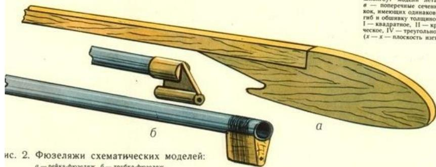
ис. 2. Фюзеляжи схематических моделей:
